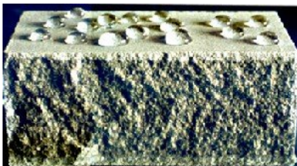
Superfície de concreto Hidrofugada
